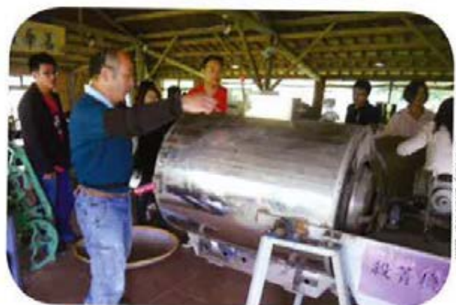
Chen demonstriert Besuchern die Tee-Verarbeitung in seiner Werkstatt. Dieses Gerät unterbricht durch Erhitzen die Fermentation des Tees.
